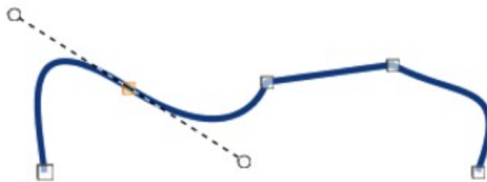
Obrázek 305: Příklad symetrického přechodového bodu
