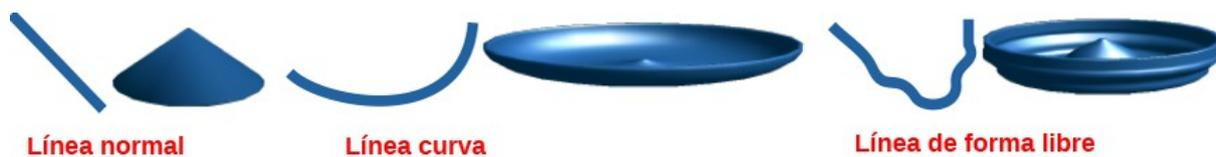
Figura 8: Conversión usando la herramienta *En cuerpo de giro 3D* (eje predeterminado)
