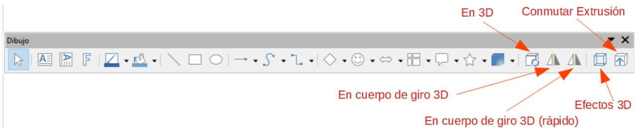
Figura 3: Barra de herramientas de dibujo con herramientas 3D
